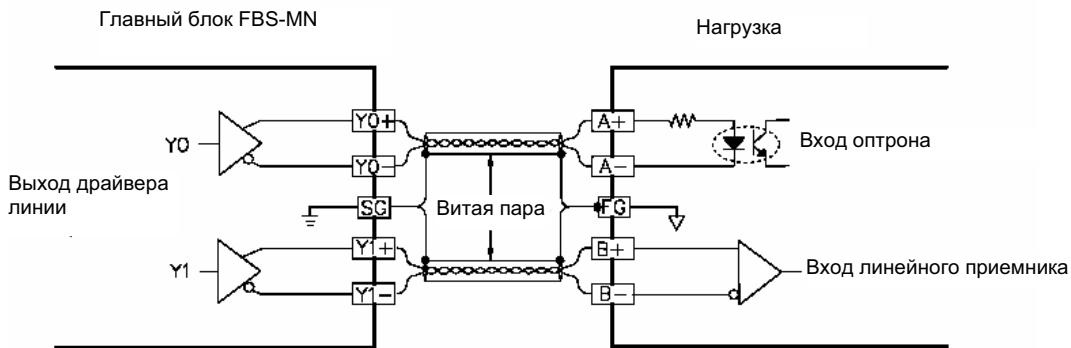
(Для частот до 750 кГц для скоростной передачи данных в условиях сильных помех)
