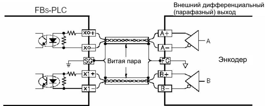
(B) Подключение дифференциального входа 5 В к источнику входного сигнала типа сток тока SINK или источнику тока SRCE (100 кГц)
