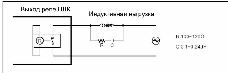
Схема нагрузки с переменным током
