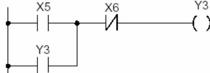
контакт типа А (ВКЛ при ВКЛ реле). Электродвигатель не работает. Если мы нажмем на кнопку X5, то реле перейдет в состояние ВКЛ, так как контакты 1 и 2 будут замкнуты, и электродвигатель начнет работать. Если после включения реле мы отпустим кнопку X5 (выключим этот выключатель ВЫКЛ), то реле сохранит свое включенное состояние благодаря обратной связи от контакта 1, это называется схемой самоблокировки реле. В следующей таблице представлен процесс переключения для описанного выше примера.
