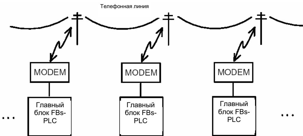
Кроме использования такого сетевого подключения, ПЛК FBs-PLC можно также соединить друг с другом с помощью модема по телефонной линии связи (выделенной или общего пользования ТФОП), при этом образуется дистанционная сеть из нескольких ПЛК. (При использовании телефонной линии общего пользования ведущий ПЛК по очереди вызывает все ведомые ПЛК.)
