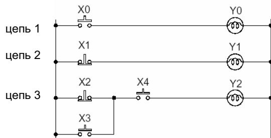
Релейно-контактная схема для ПЛК
