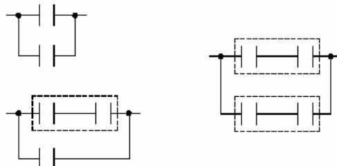
**Примечание:** При совместном использовании отдельных элементов, последовательных блоков и параллельных блоков можно составить очень сложные блоки. При проектировании релейно-контактной схемы с помощью mnemonicических обозначений необходимо разбить всю схему на отдельные элементы, последовательные и параллельные блоки. Смотрите раздел 1.5.
