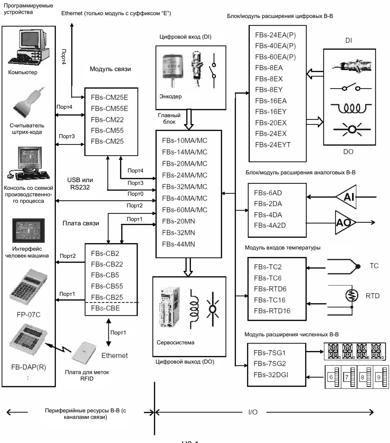
Всего ПЛК FBs-PLC поддерживает максимум 256 точек цифровых входов (DI), 256 точек цифровых выходов (DO), 64 слова численного входа (NI) и 64 слова численного выхода (NO). За счет наличия специальных интерфейсных модулей можно непосредственно подключать такие устройства, как термопары, термометры сопротивления RTD, 7-сегментные дисплеи СИД и кодовые дисковые переключатели, которые показаны выше.
