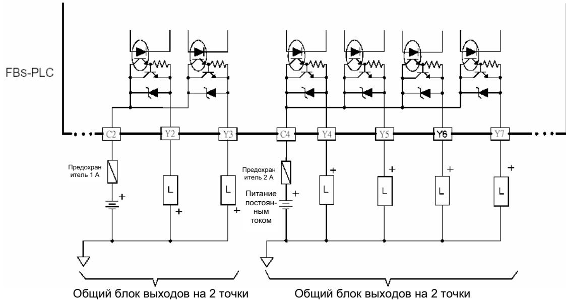
На рисунке выше показаны общие блоки выходов с 2 и 4 точками для объяснения различия между структурами выходов SINK и SRCE. (Общий блок на 8 точек имеет аналогичную структуру и разводку, но другое число точек). Несимметричные транзисторные выходы стока SINK и истока SRCE установлены в ПЛК FBs-PLC на разных моделях. Перед покупкой пользователь должен проверить структуру ее выходов - SINK или SRCE.
