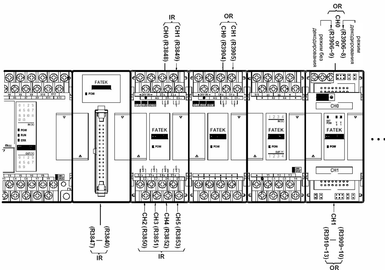
На этапе запуска ПЛК FBs-PLC автоматически определяет типы и номера каналов СН в модулях/блоках расширения. При работе ПЛК FBs-PLC считывает входные значения СН из модуля NI и сохраняет их в соответствующих регистрах IR (R3804 ~ R3903), и выводит значения из OR (R3904~R3967) в каналы в модулях NO. Пользователю не надо выполнять никакого конфигурирования или настройки.
