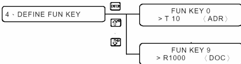
1 Всего имеется 10 настраиваемых кнопок быстрого доступа к функциям
