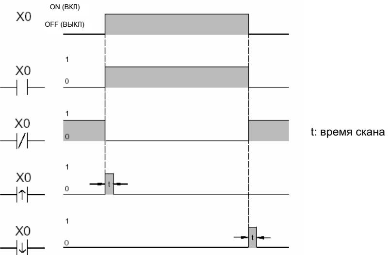
Показанные выше формы сигналов описывают поведение функций элементов A, B, TU и TD при выполнении внешним входом X0 перехода из состояния ВЫКЛ во ВКЛ и затем опять в ВЫКЛ.
